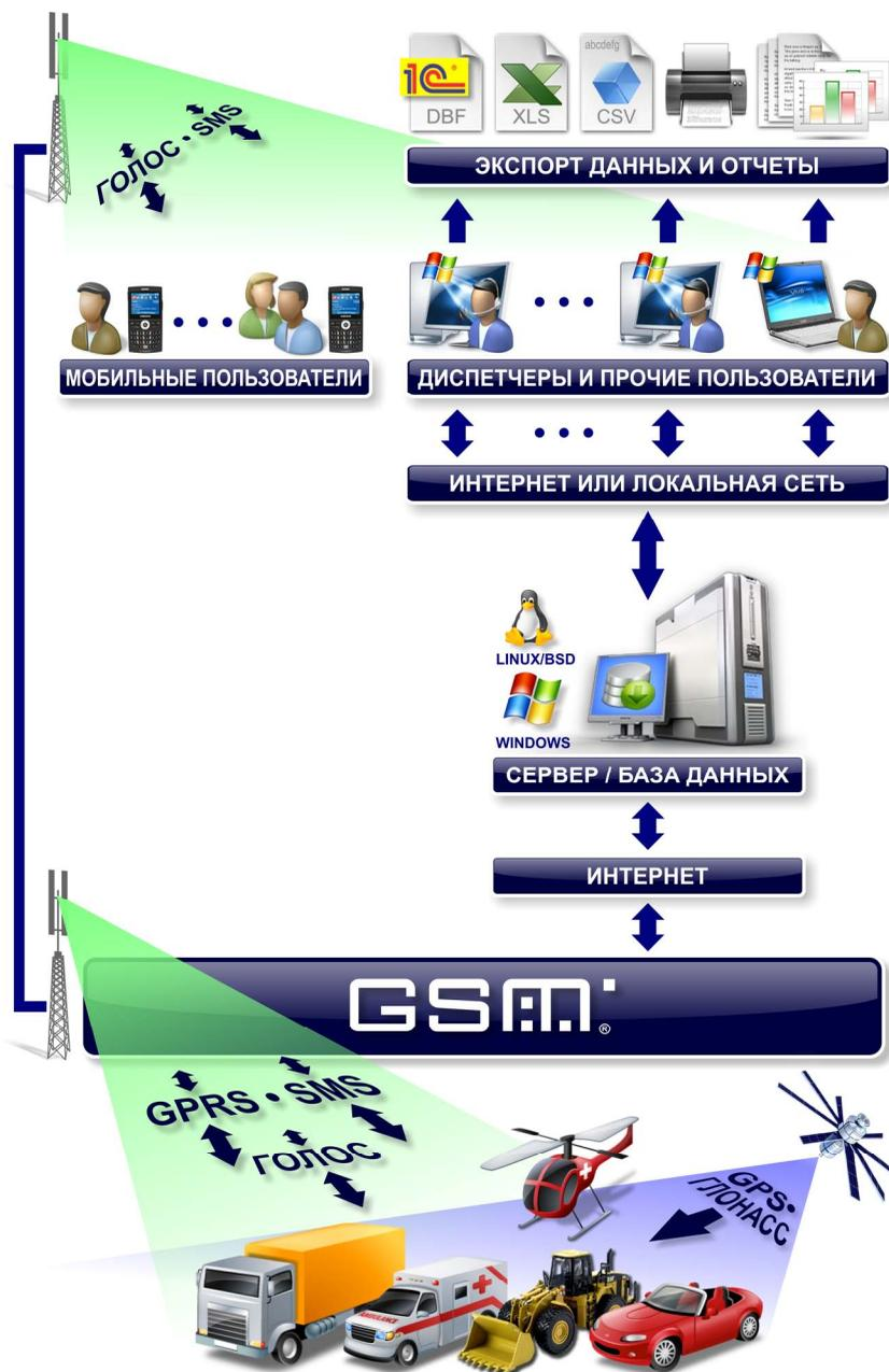
Рассмотрим краткое описание работы системы спутникового мониторинга транспорта на базе аппаратно-программного комплекса АвтоГРАФ-GSM:
