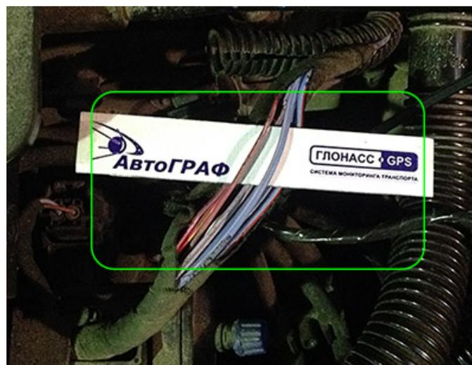
Подключение считывателя CAN-шины производить за панелью приборов.
