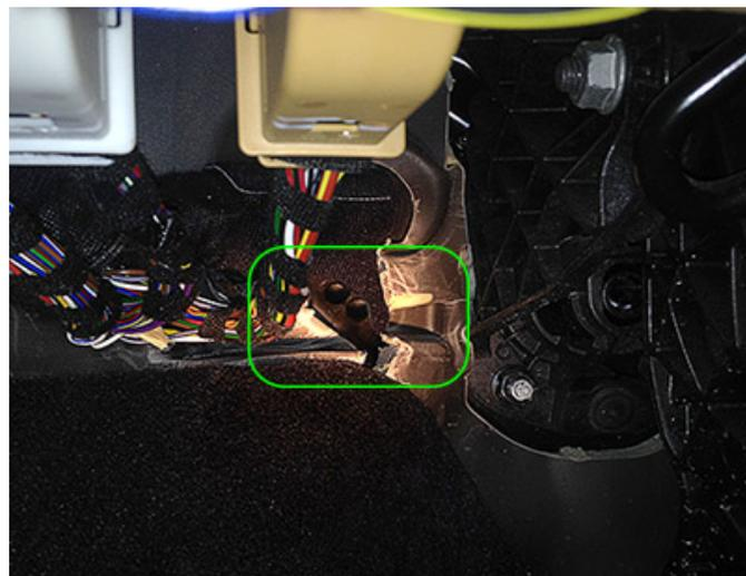
Подключение безконтактного считывателя Nozzle на красный тонкий и голубой/белый толстый провод форсунки.
