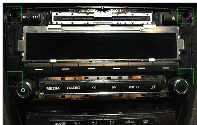
Снять внутреннюю рамку климат-контроля, потянув на себя.
