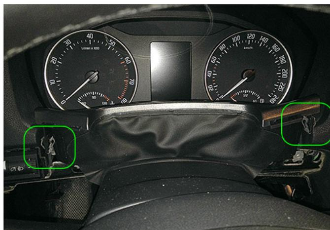
Открутить 2 самореза TORX крепления щитка приборов.
