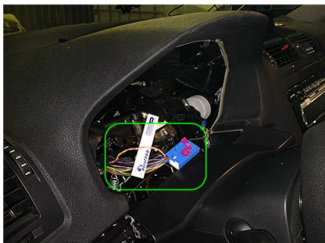
Подключить безконтактный считыватель с CANLOG.
