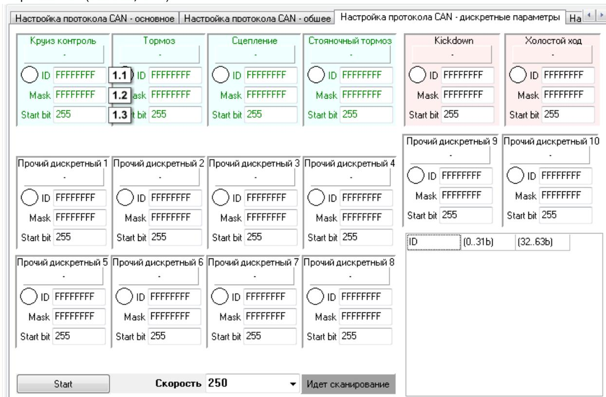
Рис.31 – Настройка протокола CAN – дискретные параметры.
