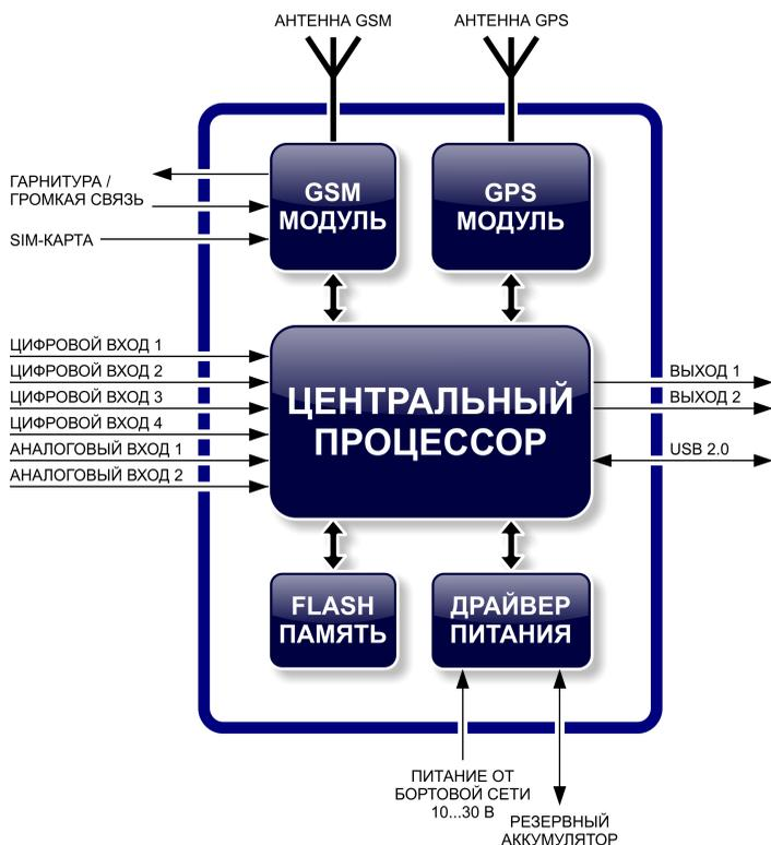
Функциональная схема контроллера АвтоГРАФ-GSM состоит из нескольких блоков:
