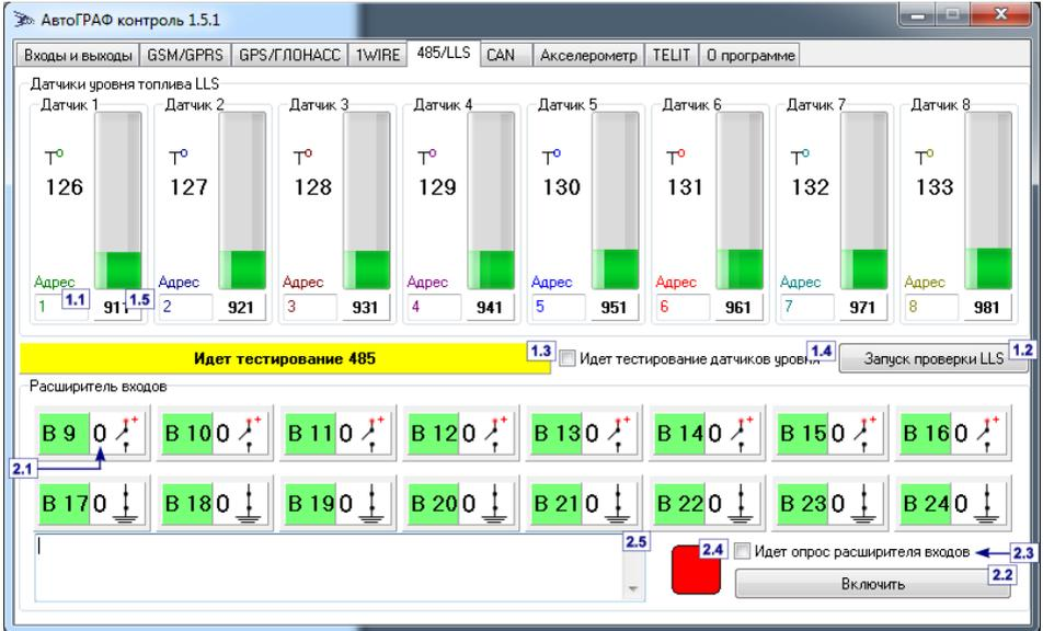
Рис.12 – Тестирование работы интерфейса RS-485.
