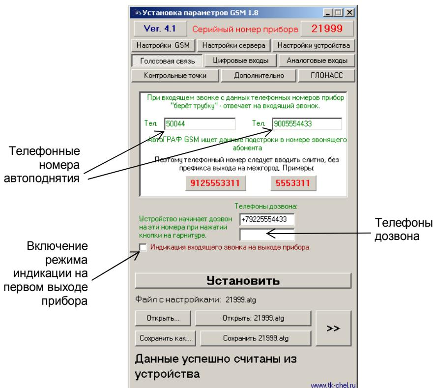
§ **Телефонные номера автоподнятия** – при входящем звонке с телефонных номеров, указанных в этих полях, устройство будет автоматически принимать звонок («поднимать трубку»). Номера следует вводить слитно, без префикса выхода на междгород. Автоматический приём входящего звонка происходит, если строка телефонного номера звонящего абонента содержит в себе подстроку первого либо второго телефонного номера.
