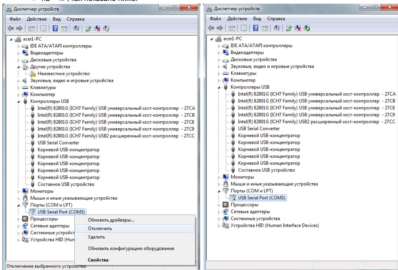
Рис.28 - Отключение последовательного порта.
