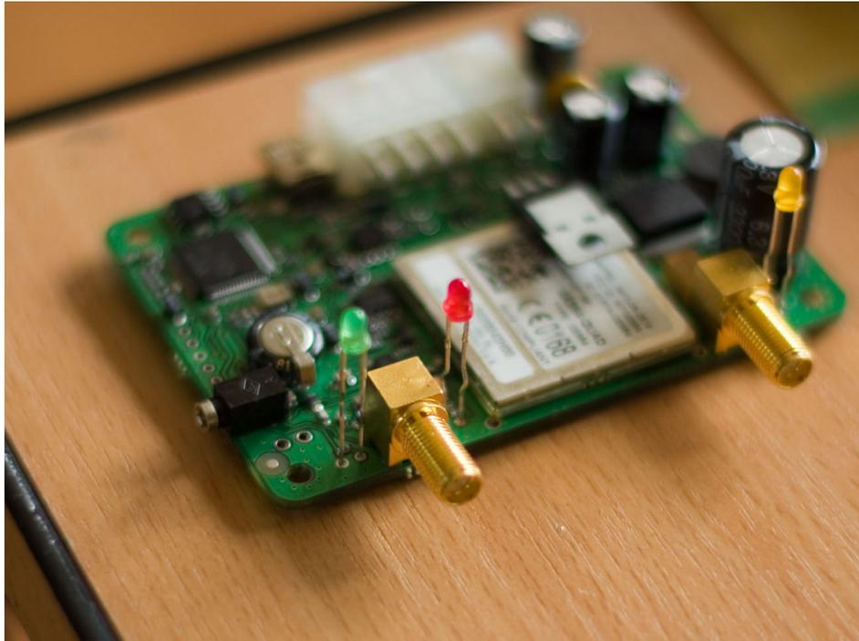
2. Отогните светодиоды, и зажмите корпус разъема в тисы. Зажимать нужно за корпус, таким образом, чтобы не зажать фланец.
